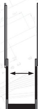
СКВАЖИНЫ С ЗАЦЕМЕНТИРОВАННЫМ ХВОСТОВИКОМ (ХВОСТОВИК ОТ 102 ММ)
