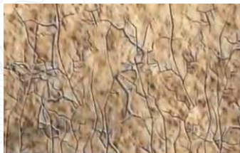
Сеть остаточных трещин в пласте
