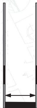
ЭКСПЛУАТАЦИОННАЯ КОЛОННА ОТ 102 ДО 178 ММ, ГЛУБИНЫ ОТ 250 ДО 8000 М
